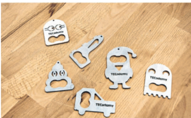
Der Laser in der Lernfabrik 4.0 schneidet die selbst konstruierten Flaschenöffner der Realschüler in Sekundenschnelle aus.
